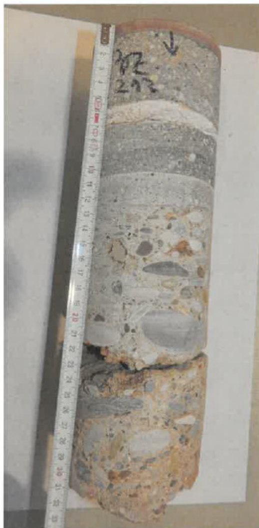
Slika 12 Slojevi podne ploče WC-a, podrum na ispitnom mjestu POZ 212
