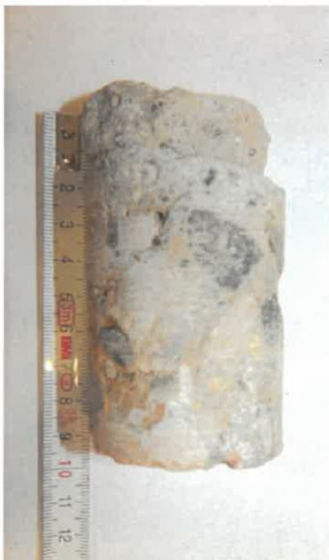
Slika 10 Slojevi unutarnjeg zida strojarnice dizala, podrum na ispitnom mjestu POZ 204
